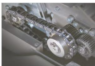
**SUPER POTENTIAL POWER SYSTEM:** trasmissione a catena con ingranaggi in acciaio.
